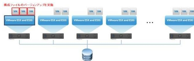
この手順をホストマシンの台数分繰り返すことで、既存の仮想マシンを移動させたままホストマシンのバージョンアップが可能となり、仮想マシンの停止を仮想マシンの構成ファイルのバージョンアップ作業時間のみに抑えることが可能となります。
